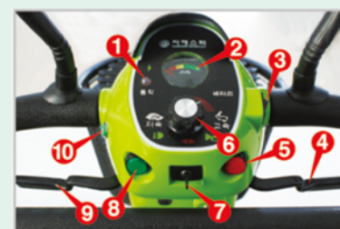
1. 동작램프 2. 배터리잔량표시창 3. 비상등 4. 전진레버 5. 경고음버튼 6. 속도조절노브 7. 방향동레버 8. 전조등버튼 9. 후진레버 10. 기어수동변환버튼(بات데리장착시 작동안됨)
